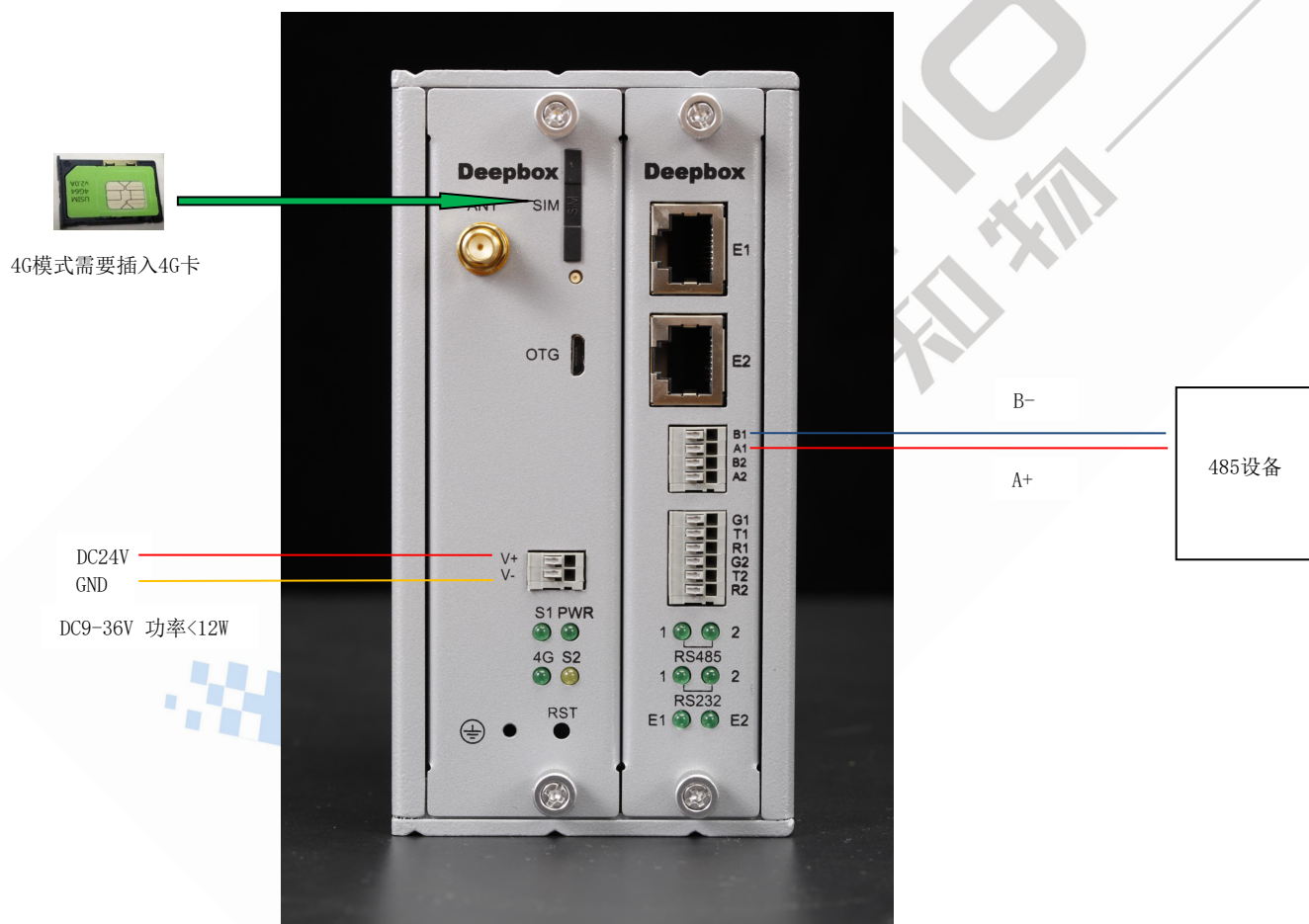
图 1-6 DEEPBox 产品的硬件连接
